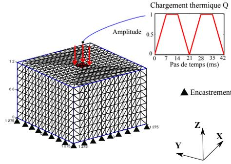
FIGURE 1 – Géométrie et conditions aux limites
